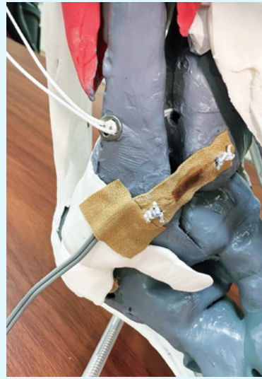
踝關節韌帶聯合固定結合感測器示意圖
