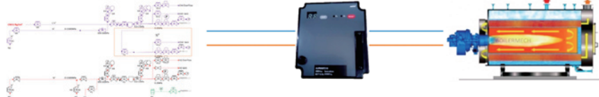
混氫燃燒器與系統測試驗證
